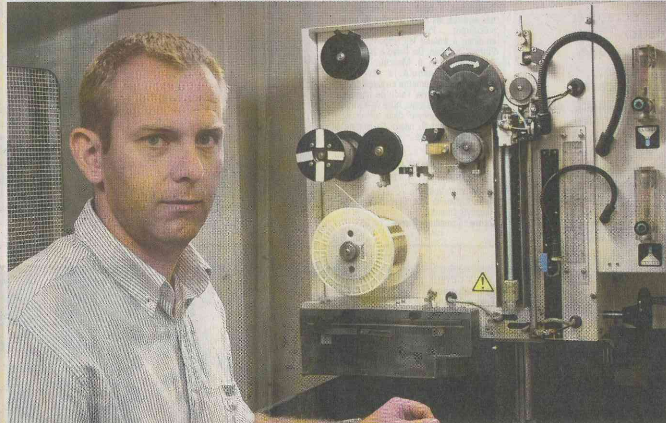
L'investissement de l'entreprise : une machine de découpe par électroérosion. Cette petite merveille, achetée d'occasion, a coûté 43 000 euros. Elle consiste à couper l'acier avec un fil de laiton dans lequel passe un courant électrique. Le financement permet à Prime de se diversifier et surtout de ne plus avoir à sous-traiter les commandes des clients.
